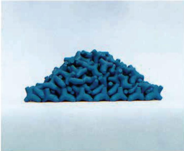
写真－8 乱積傾斜堤
